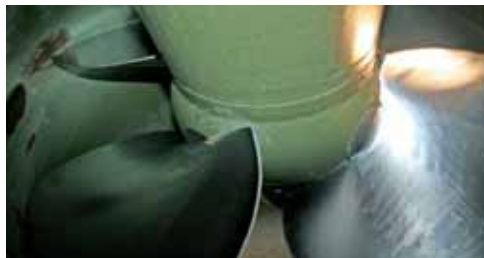
links oben: Blick auf das vierflügelige Kaplan-Laufrad links unten: Visualisierung der Einbausituation der neuen Turbine rechts: Über einen Flachriemen wird ein umgebauter Synchron-generator angetrieben. Die Maschine leistet heute rund 110 kW.
